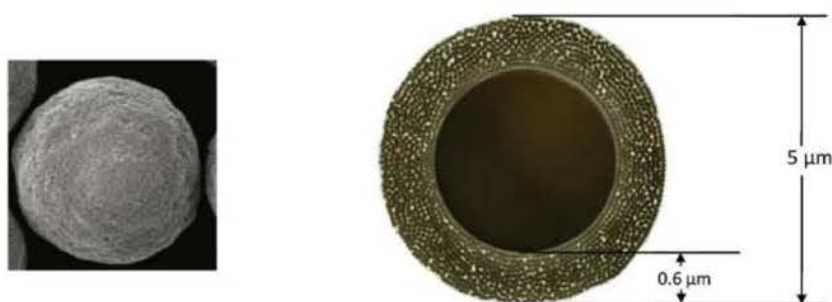
图 1-10 5\ \mu\text{m} 核壳材料的结构
